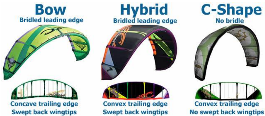
Figura 6. Diferencia ilustrativa entre los tres tipos de kites
